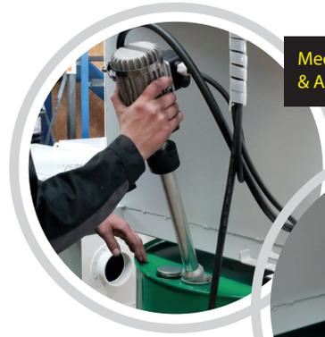
Medienpumpe & Ansaugrohr
