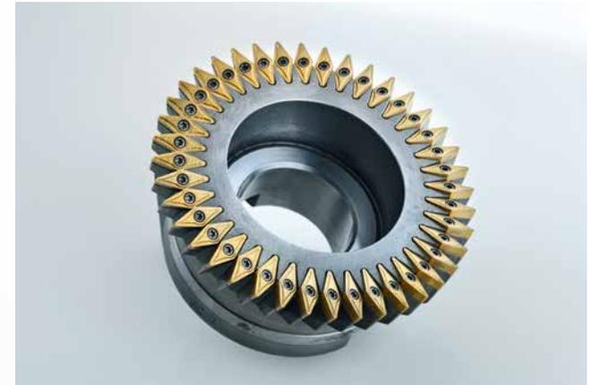
Großes Bild: zylindrisches Schälwerkzeug
