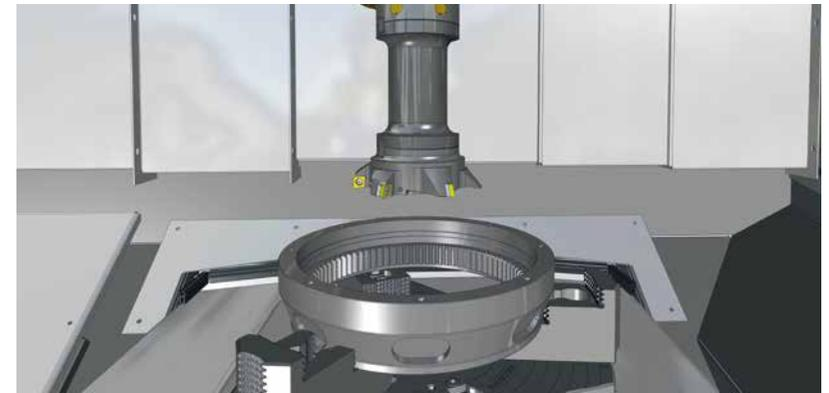
Das wahre Potenzial des PITTLER MultiTools zeigt sich in der praktischen Anwendung, wie anhand des bereits umgesetzten Beispiels eines Planetenradhohlringes deutlich wird. Bei diesem äußerst präzisen Getriebeteil ist es erforderlich, sowohl Innen- als auch Außenbearbeitungen in einer einzigen Aufspannung durchzuführen, inklusive Schruppen und Schlichten.
