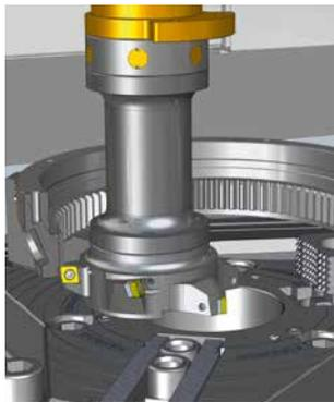
Der MultiTool-Kopf dreht in nur 0,3 Sekunden die jeweils benötigte Schneidengeometrie in die Bearbeitungsebene. Längs- und Plandrehoperationen sowie Hinterschnitte und Einstiche mit unterschiedlichen Werkzeuggeometrien werden so ermöglicht. Alternativ können an den Schneidpositionen geometrisch gleiche Werkzeuge verwendet werden, die beim Standzeitende eingedreht werden.
